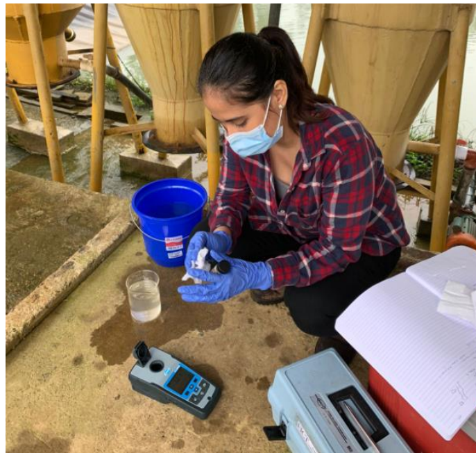
Figura 2.6 Análisis de la turbidez en campo mediante el uso del turbidímetro portátil marca HACH.
