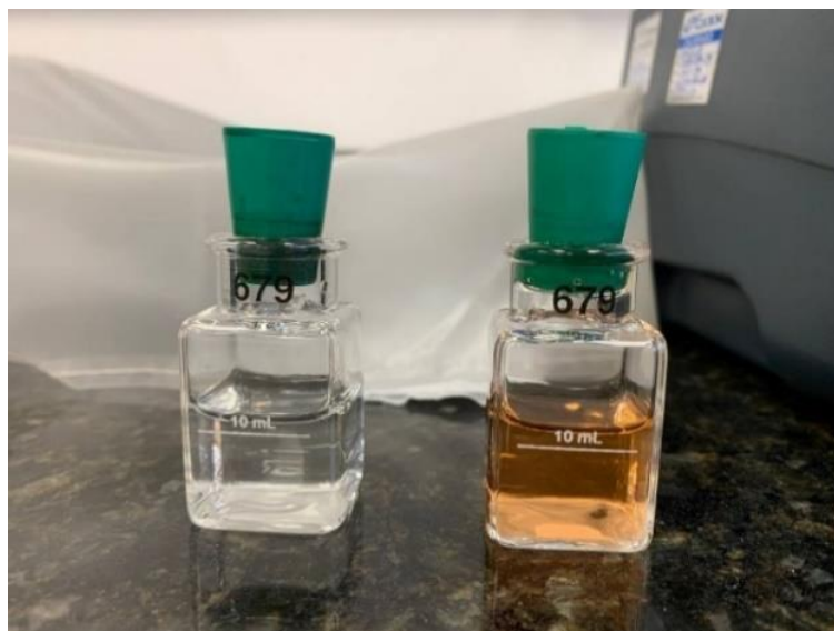
Figura 2.5 Cubeta HACH 2495402, en el lado izquierdo se muestra el blanco que es la muestra sin alterar, y en lado derecho se observa la cubeta con la muestra y el reactivo.
