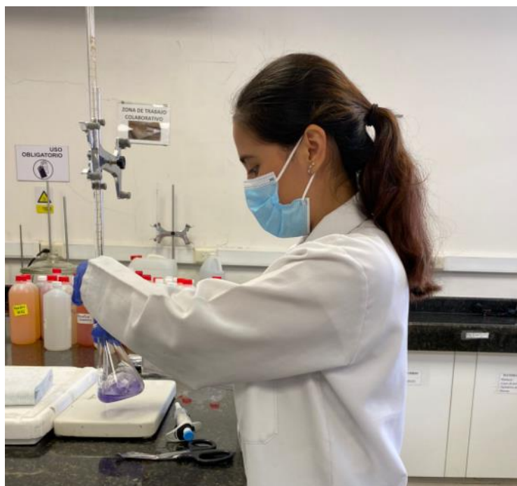
Figura 2.4 Medición de la concentración de calcio mediante el método volumétrico usando como titulante EDTA.
