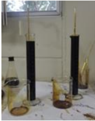
Figura 2.6 Medición de grados API en el laboratorio (Autor, 2022)
