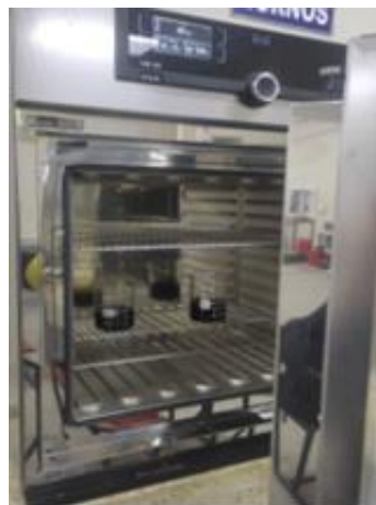
Figura 2.7 Uso del horno para calentar muestras de crudo en el laboratorio (Autor, 2022)
