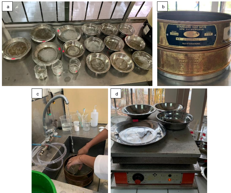
Figura 2.3. Ejemplo del uso del método del levigado (a) procesamiento de las muestras en peróxido de hidrógeno, (b) tamices N° 60, N° 230 (c) lavado de muestras y (d) secado de muestras en plancha de calentamiento
