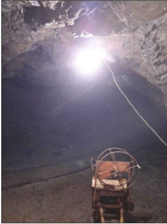
Fotografía 1.6 Iluminación empleada en la mina de OROSOL UNO
