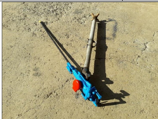
Fotografía 1.5 Perforadora neumática empleada en la mina de OROSOL UNO
