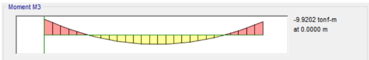
Figura 3-7. Momento máximo producido en viga secundaria metálica
