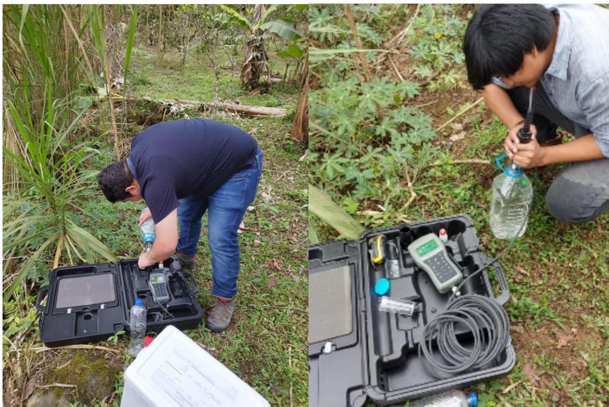
**Figura 2.12. Preparación del equipo y medición de muestras obtenidas del rio San Antonio y Escaleras**
