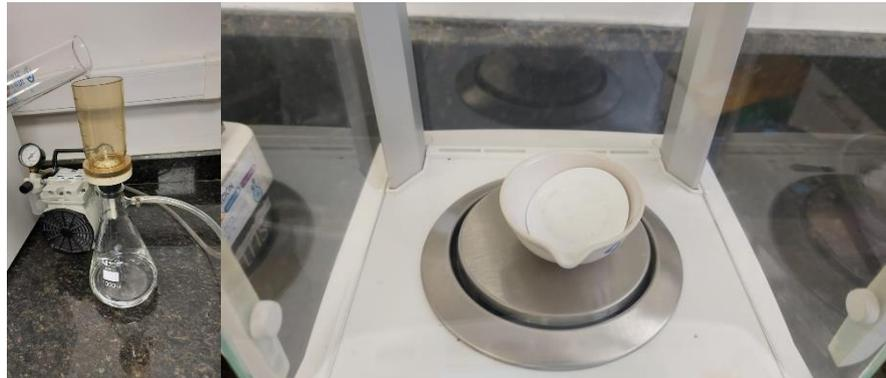
**Figura 2.15 Ensayo Análisis de Solidos**
