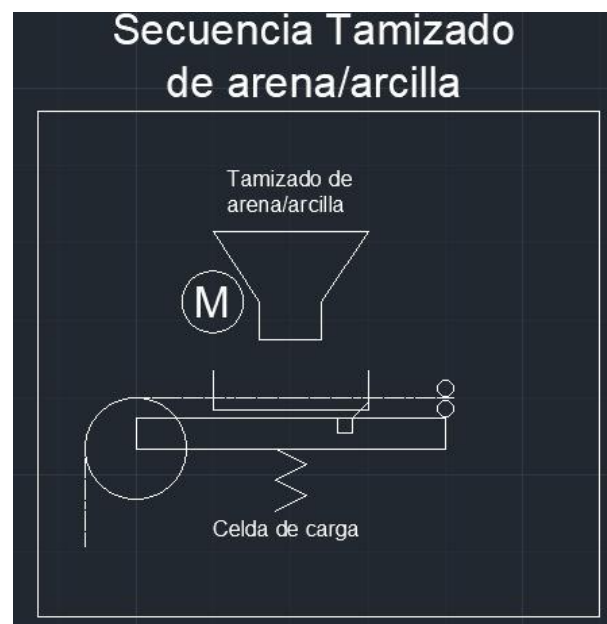
Figura 2.1.2: Secuencia de tamizado usando motor de 2 HP.
