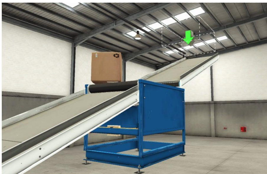
Figura 3.1.5: Pesaje de la chatarra mediante la celda de carga.
