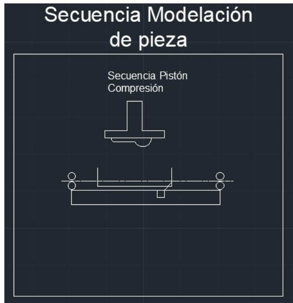
Figura 2.1.4: Secuencia de modelación de arena/arcilla mediante pistones.
