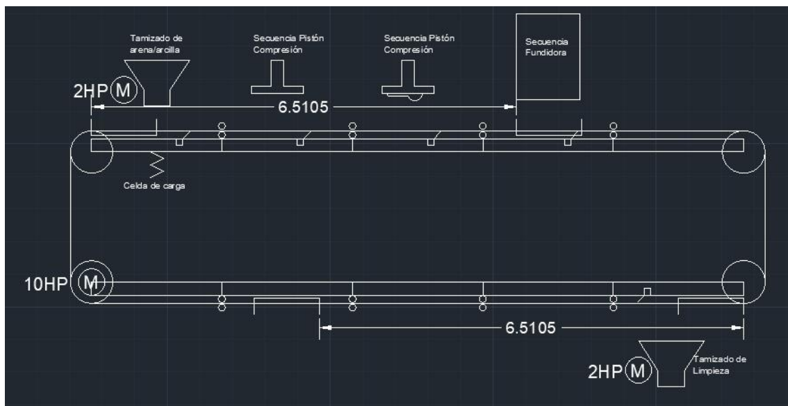
Figura 2.1.1: Esquema de línea de producción.
