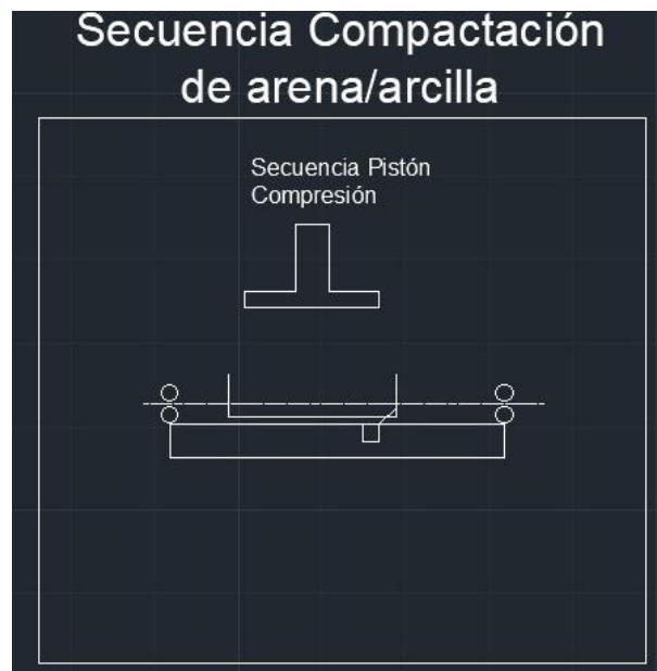
Figura 2.1.3: Secuencia de compactación de arena/arcilla mediante pistones.
