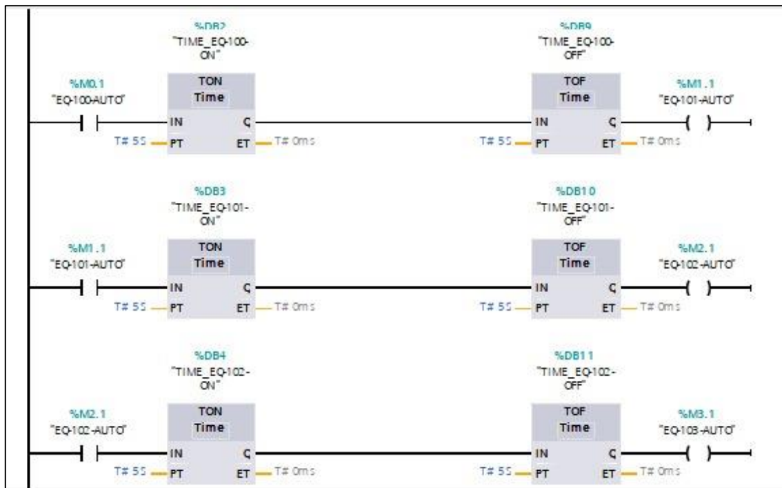
Figura 23. Programación del proceso automático llenado
