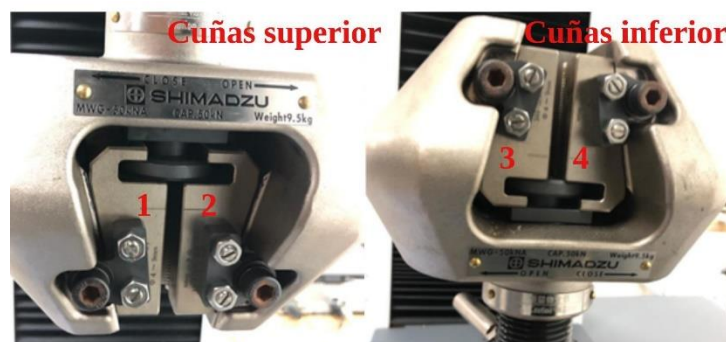
Figura 2.16. Modelo MWG-50KNA de cuñas con capacidad de 50 KN utilizados en el ensayo de compresión
