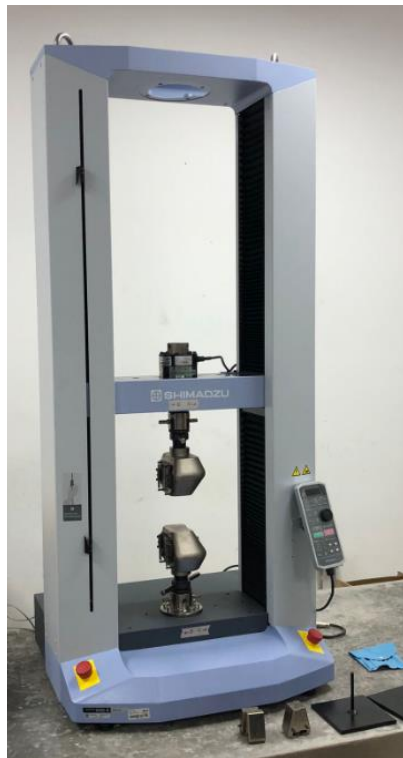
Figura C 2. Máquina de ensayos universales del laboratorio de solidos de ESPOL Shimadzu AutoGrah modelo AGS-50kNX
