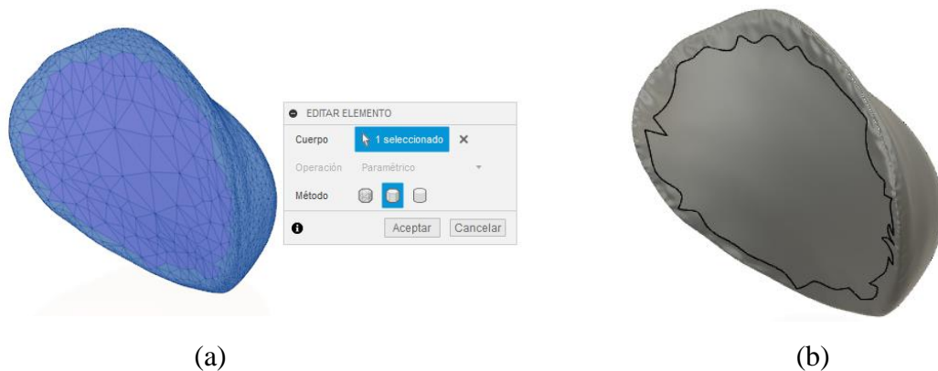
Figura A 5. (a) Parámetros definidos en la conversión de malla a sólido, (b) Modelo de prótesis sólido dividido en 2 grupos de caras
