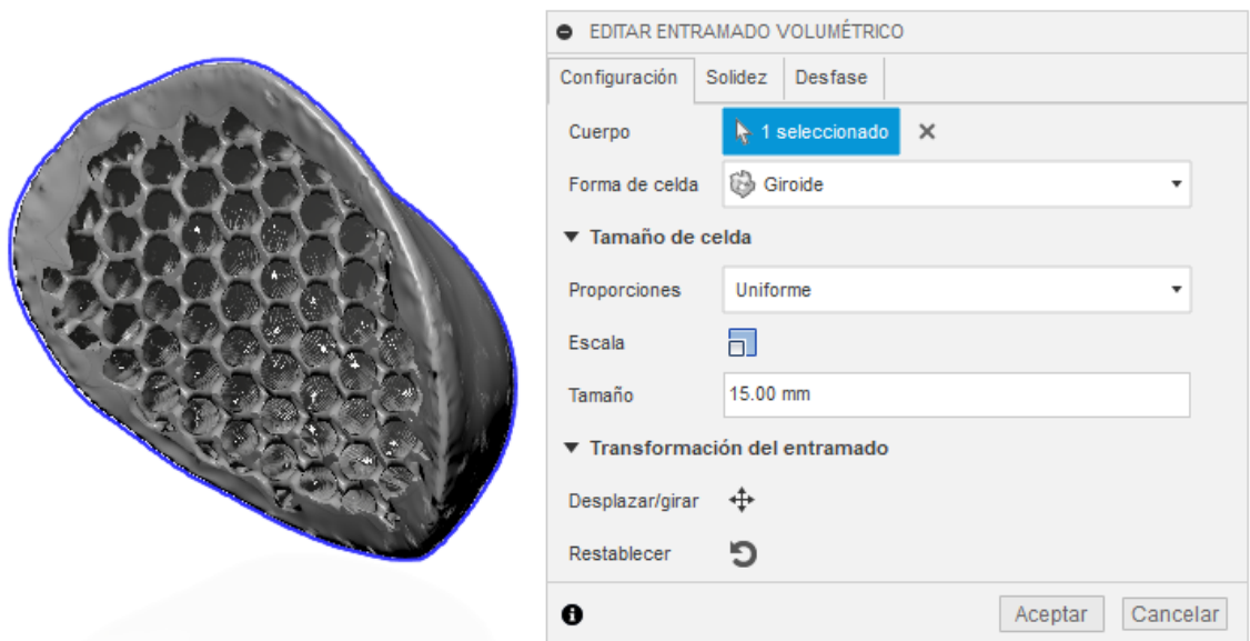
Figura A 6. Diseño de la estructura de red interna de la prótesis utilizando la función de entramado volumétrico de Fusion 360
