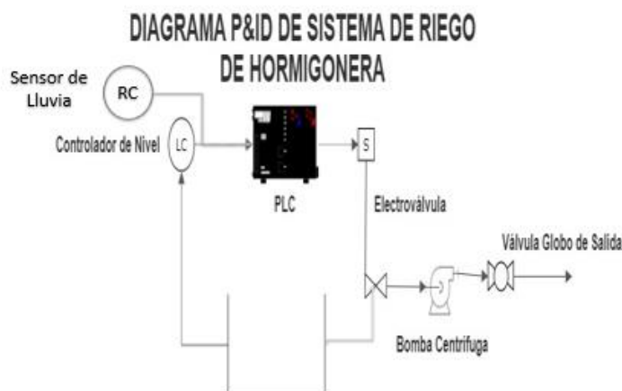
Figura 24. Diagrama P&ID del sistema
