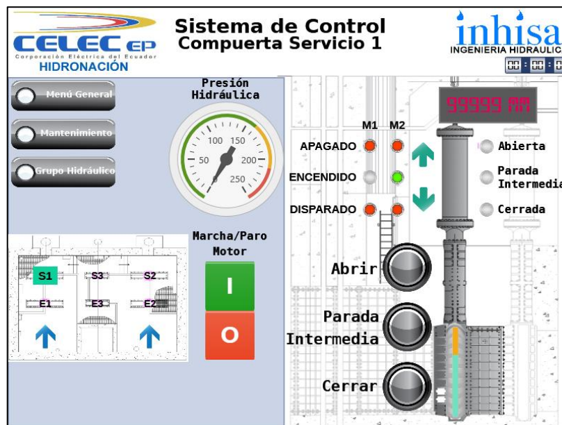
Figura 18.-Pantalla de operación de compuertas [3].
