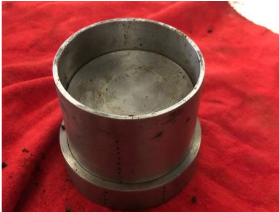
Imagen B5: Inserción del disco para moldear la biomasa.
