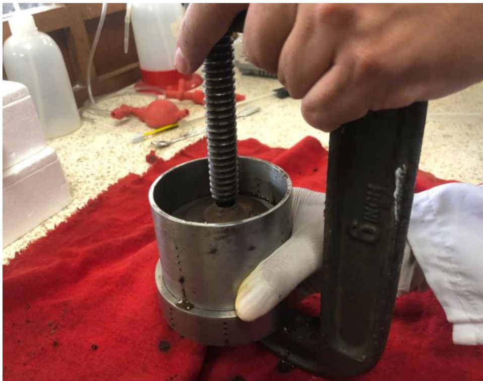
Imagen B6: Imagen de la briquetera siendo sometida a presión con una prensa mecánica.
