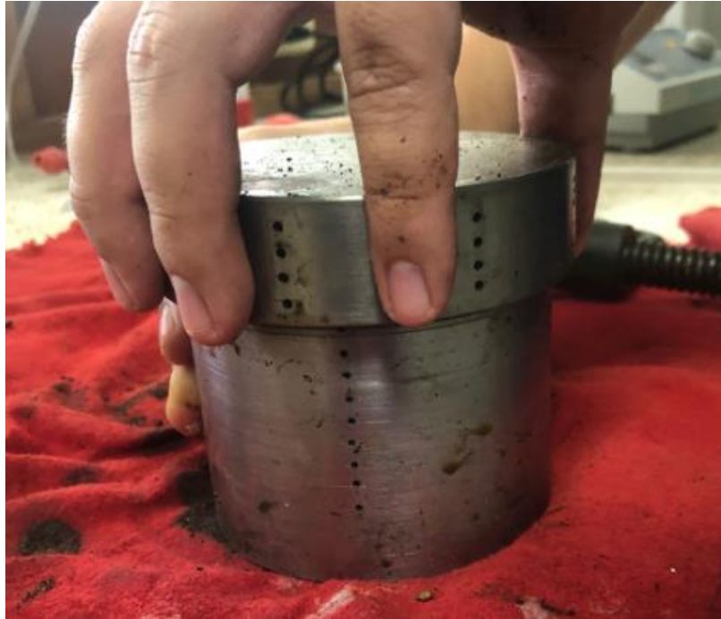
Imagen A8 y A9: Inserción de la parte A con la parte D que se utiliza como herramienta para la liberación de la briqueta.
