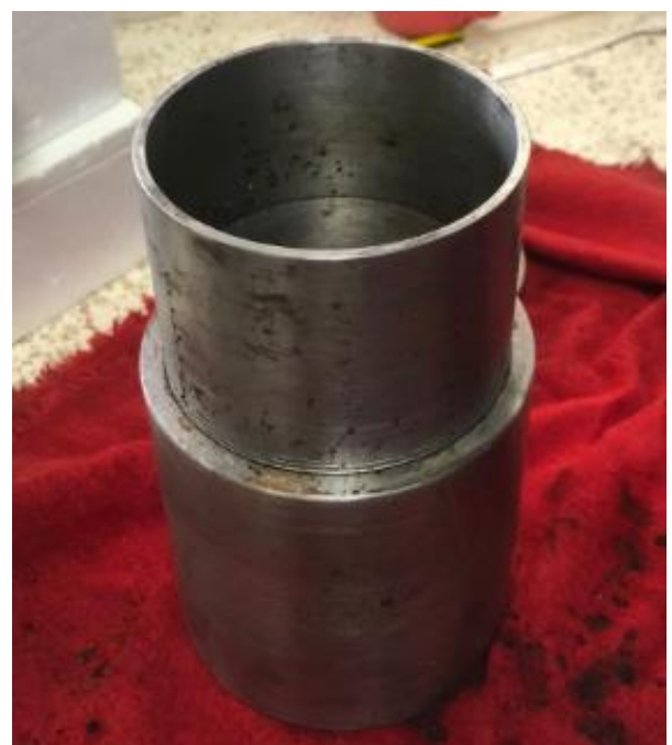
Imagen A8 y A9: Inserción de la parte A con la parte D que se utiliza como herramienta para la liberación de la briqueta.
