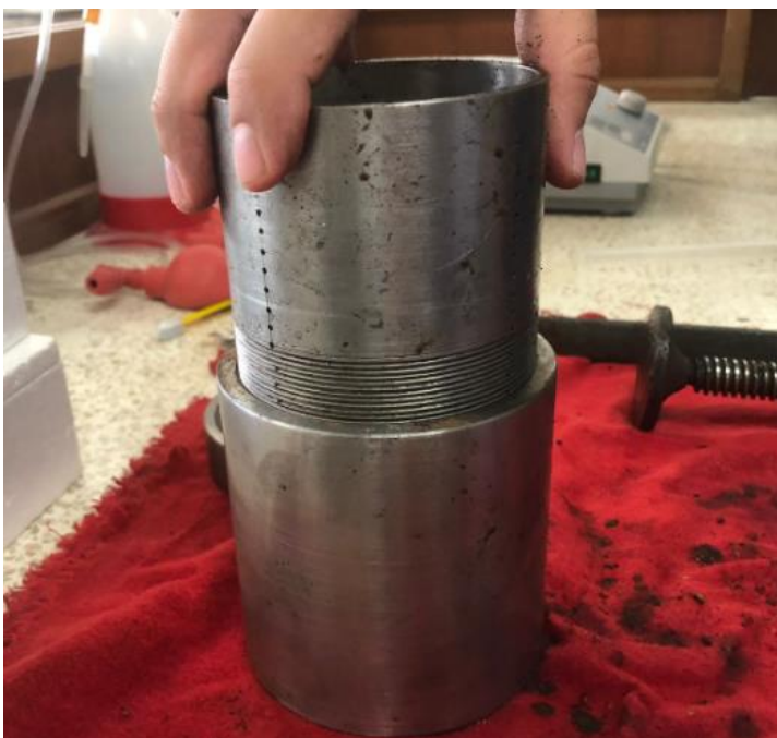
Imagen A8 y A9: Inserción de la parte A con la parte D que se utiliza como herramienta para la liberación de la briqueta.
