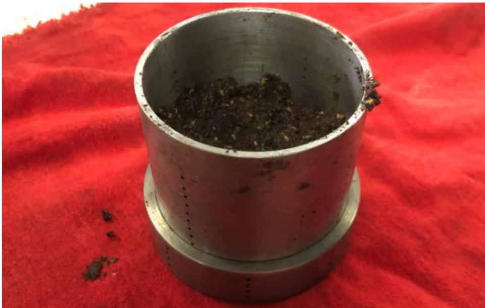
Imagen B4: Adición de mezcla con aglutinante dentro de la briquetera.
