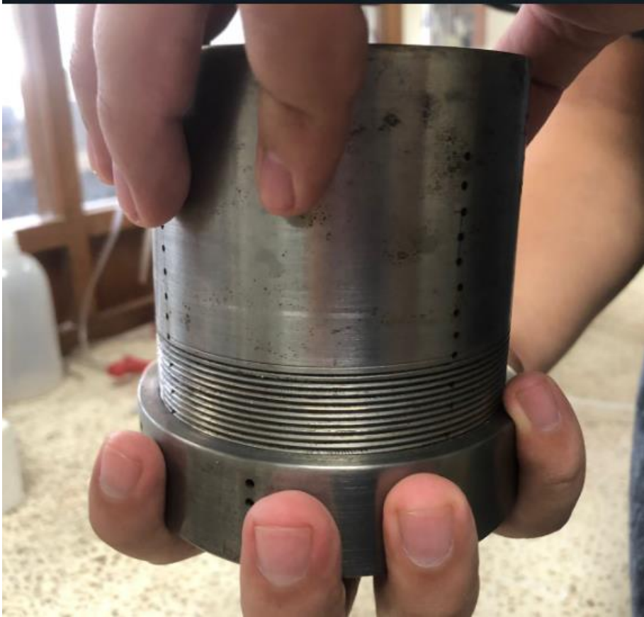
Imagen B3: Enroscado de la briquetera (Pieza A con Pieza C).
