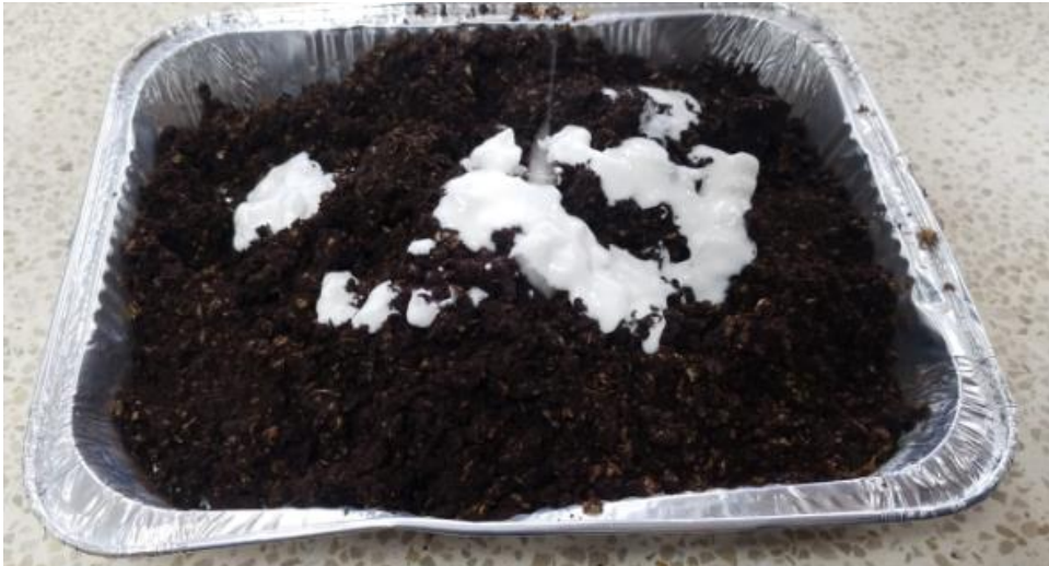
Imagen B2: Adición de aglutinante gelatinizado.
