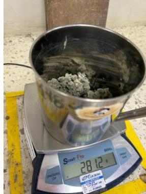
*Nota.* Se pesa la materia prima luego de secarse en el horno para determinar la humedad de la muestra.
