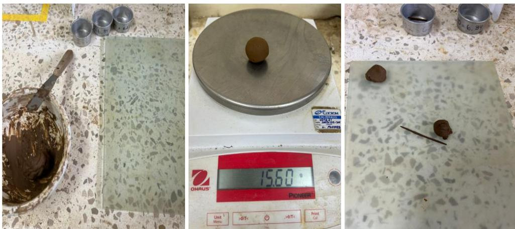
Al analizar los resultados obtenidos se puede llegar a la conclusión que el lodo presenta características de un suelo limoso elástico, esto se lo determina mediante el uso de la Carta de Plasticidad junto con los valores obtenidos de LL y el IP, se lo puede ver en la Figura 7, la cual permite que se realice la clasificación de los suelos mediante el sistema AASHTO.
