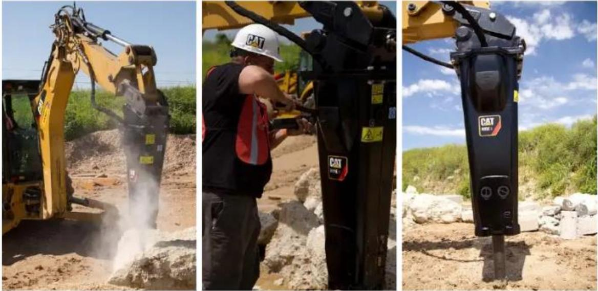
Ilustración 3-4 Martillo hidráulico. Fuente: Propia
