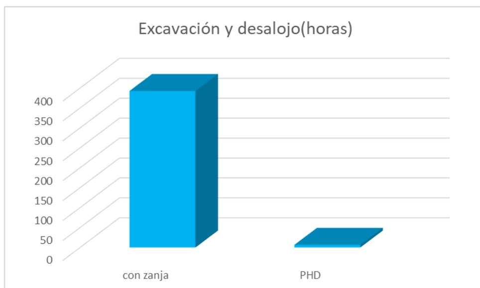
Ilustración 4-6 Tiempo de ejecución de trabajos de excavación y desalojo en horas por método. Fuente: Propia
