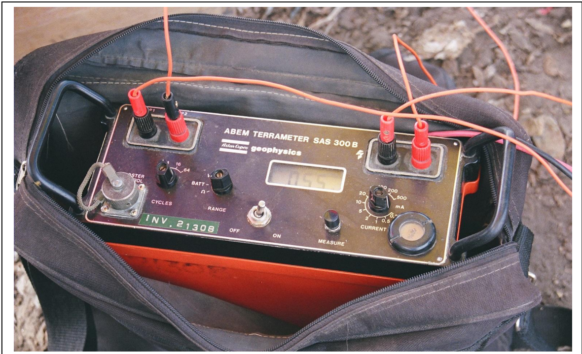
Equipo de resistividad eléctrica utilizado en actividad de campo
