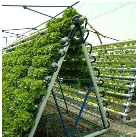
Figura 26. Modelo de modulo piramidal para hidroponía
