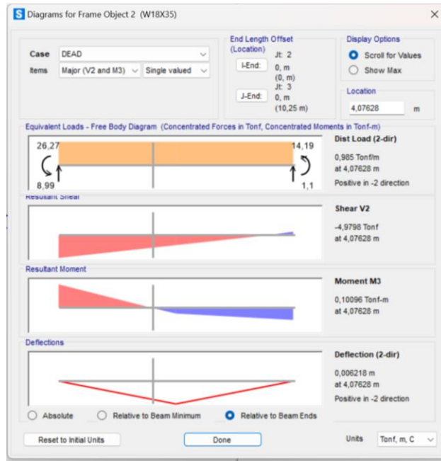
Figura 3.13 Ubicación del momento nulo del cordón inferior (Aguayo-Medina, 2023)
