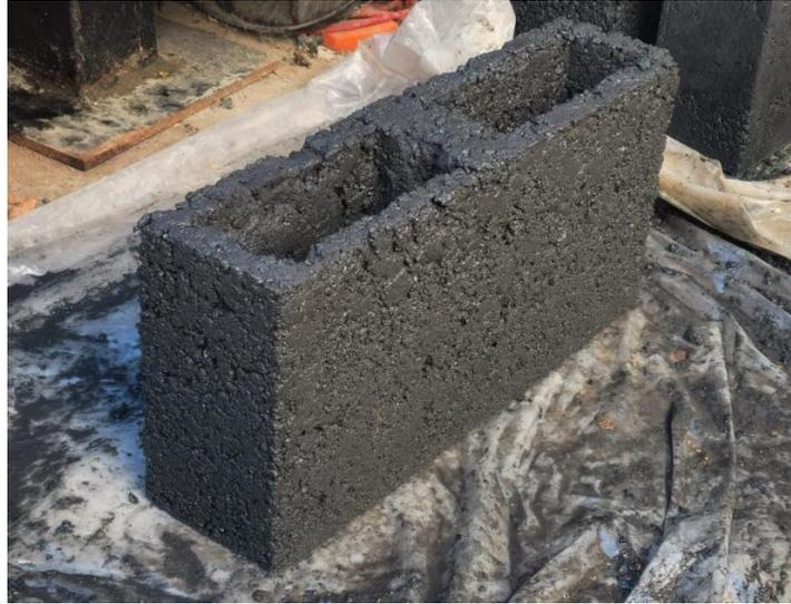
**Figura 3.15 Bloque CBCA elaborado en molde metálico (Aguirre & Zurita, 2023)**
