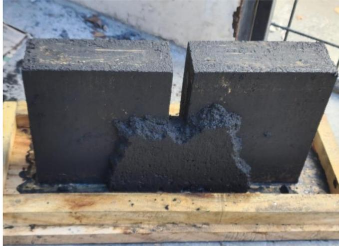
**Figura 3.11 Material adherido a las paredes del molde (Aguirre & Zurita, 2023)**
