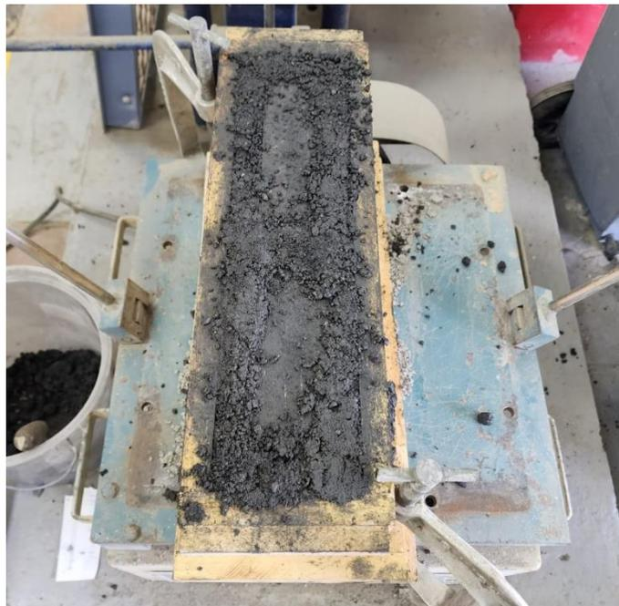
**Figura 3.10 Vibrado para molde de madera (Aguirre & Zurita, 2023)**
