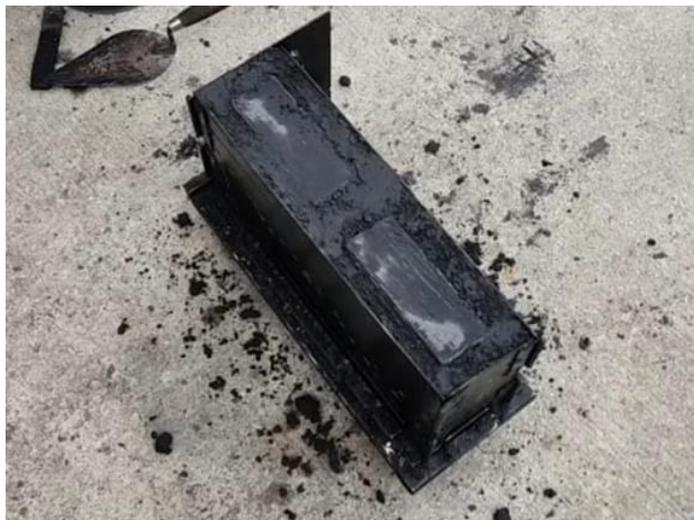
**Figura 3.14 Material compactado en molde metálico (Aguirre & Zurita, 2023)**
