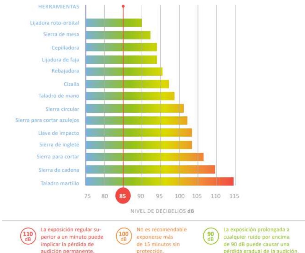
Ilustración 53. Nivel de decibelios por herramienta. Extraído de "Guía de medición de ruido en obras de construcción", Gobierno de España.
