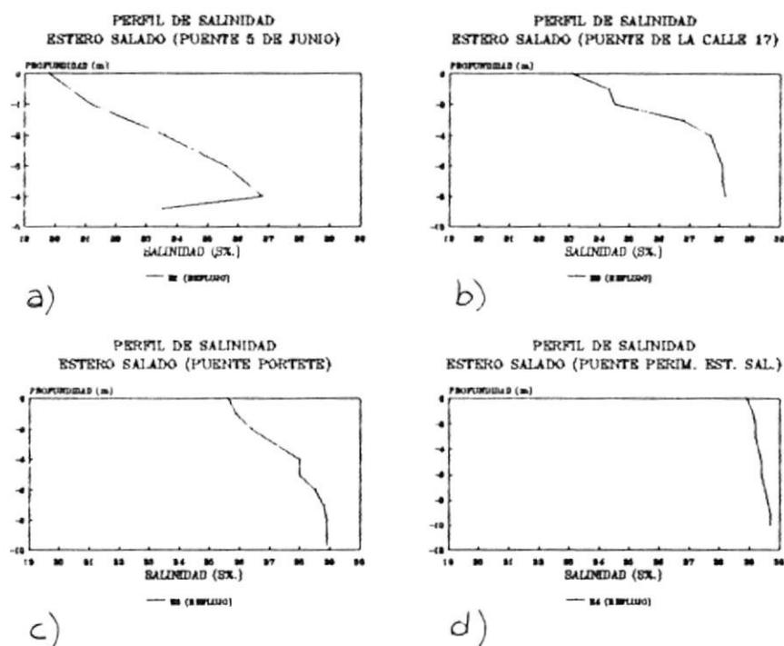
Fig. 42 Perfiles de Salinidad, estaciones 1,2,3 y 4
