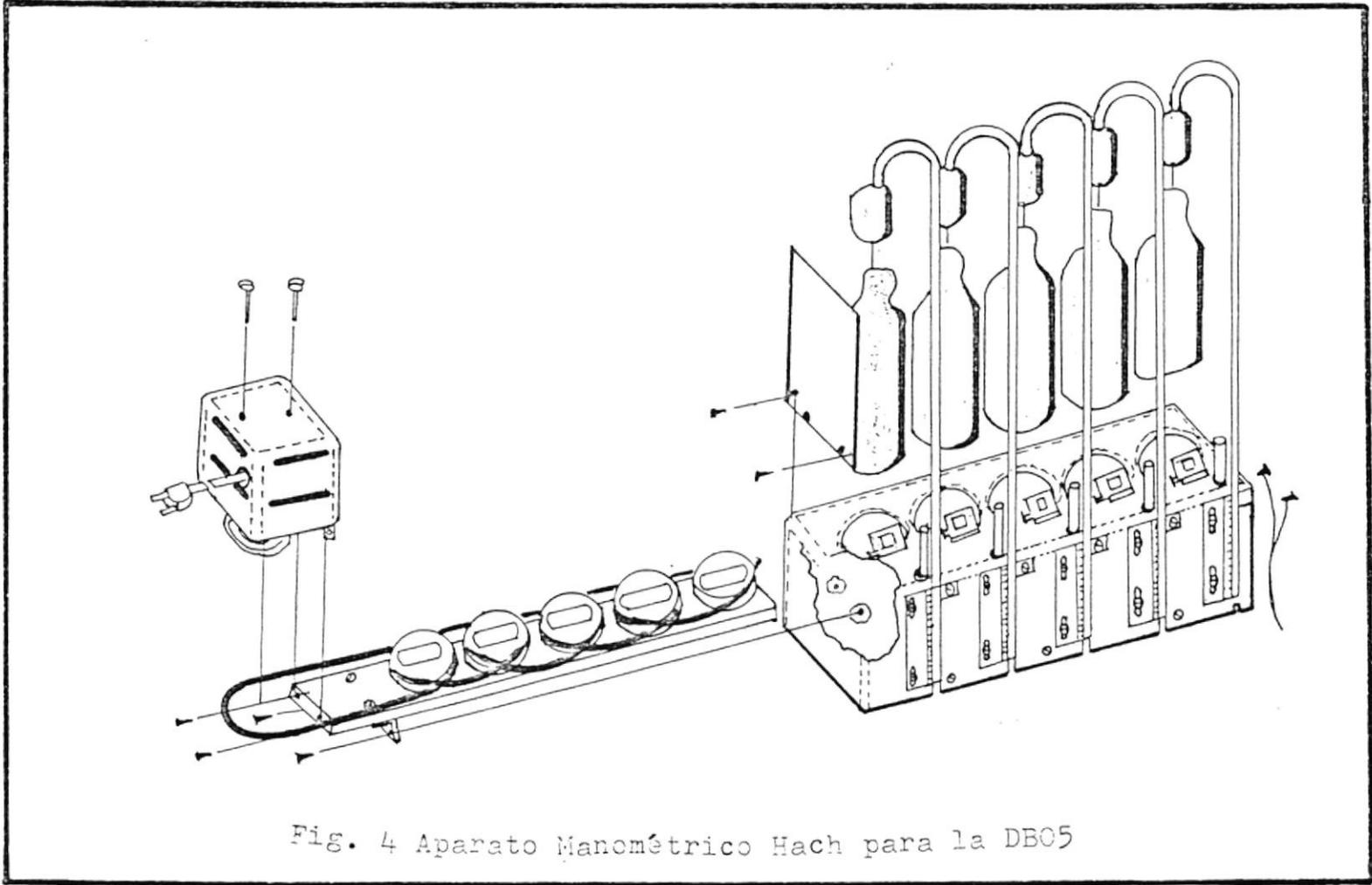
Fig. 4 Aparato Manométrico Hach para la DB05
