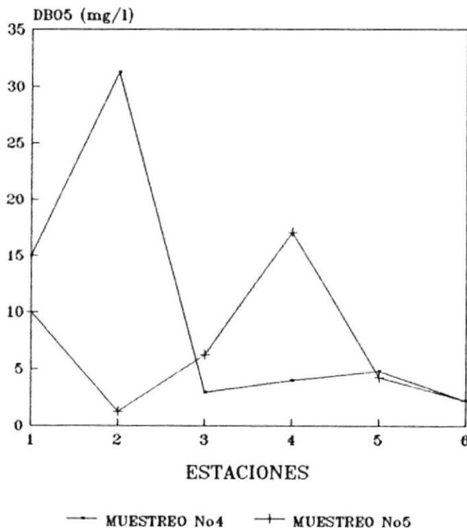
FIG. 16 DBO 5 días, Winkler, 4to. y 5to. muestreo
