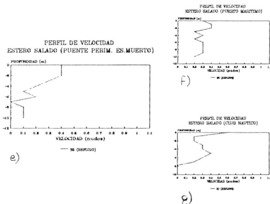
Fig. 41 Perfiles de Corrientes, estaciones 5 y 6
