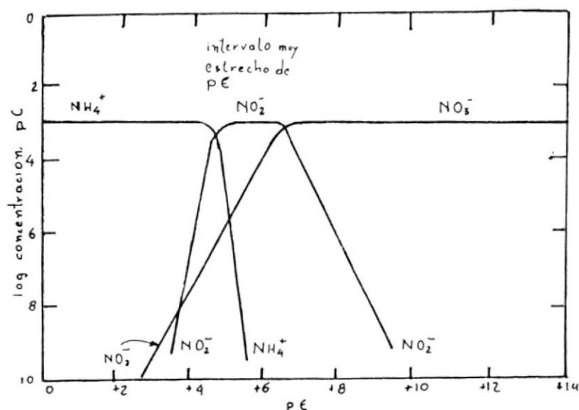
Diagrama pC - pE para los especies de nitrógeno ( $C_N = 10^{-3}$  M pH 8) omitiendo gas nitrógeno y  $\text{N}_2$  acuoso.
