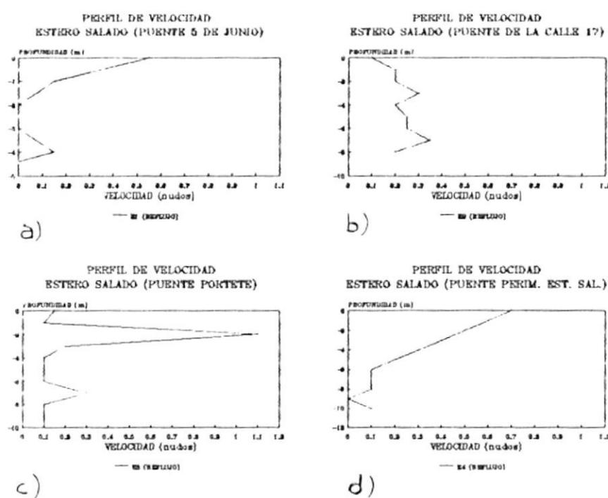
Fig. 40 Perfiles de corrientes, estaciones 1,2,3 y 4
