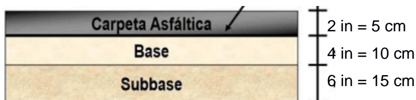
Figura 3.16 Espesores de las capas del Pavimento.
