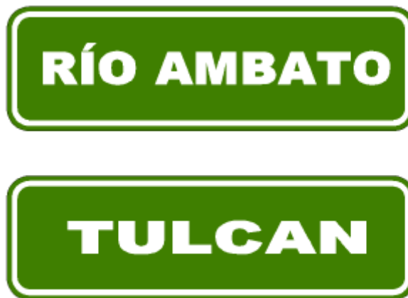
Figura 3.40 Señalización de información de lugares. [INEN Señalización vial parte 1, 2011, pág.105]
