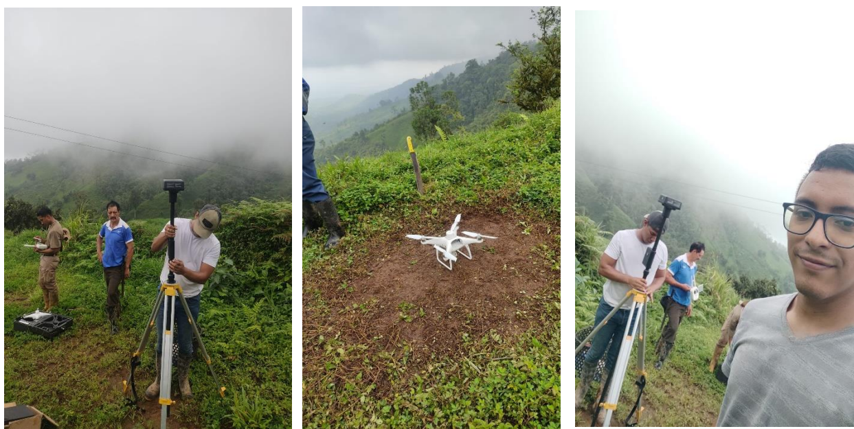
Figura 2.5 Levantamiento topográfico realizado con Dron y visualización de dos puntos de control. [Castro & Fajardo, 2023]
