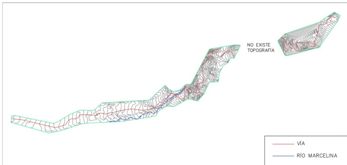
Figura 2.13 Alternativa 2 del trazado de la carretera recinto Colombia Alta- recinto el Recreo. [Castro & Fajardo, 2023]
