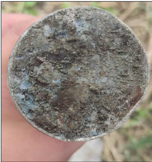
Figura 3.3 Obtención de muestra suelo arcilloso con intercalación de arenas finas a 1 metro. Fuente: Eva Chacón y Brayan Pinto
