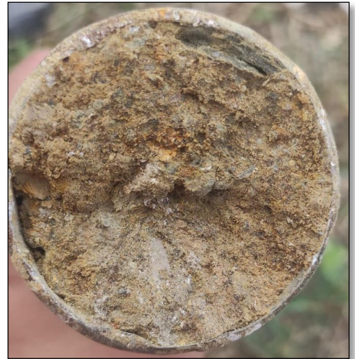
Figura 3.4 Obtención de muestra suelo arcilloso a 2 metros. Fuente: Eva Chacón y Brayan Pinto
