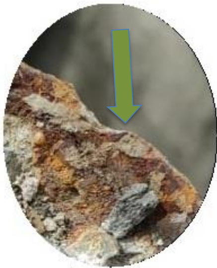
Figura 3.20 Zoom tubería de acero con sección de espesor reducido a 1 mm. Fuente: Eva Chacón y Brayan Pinto
