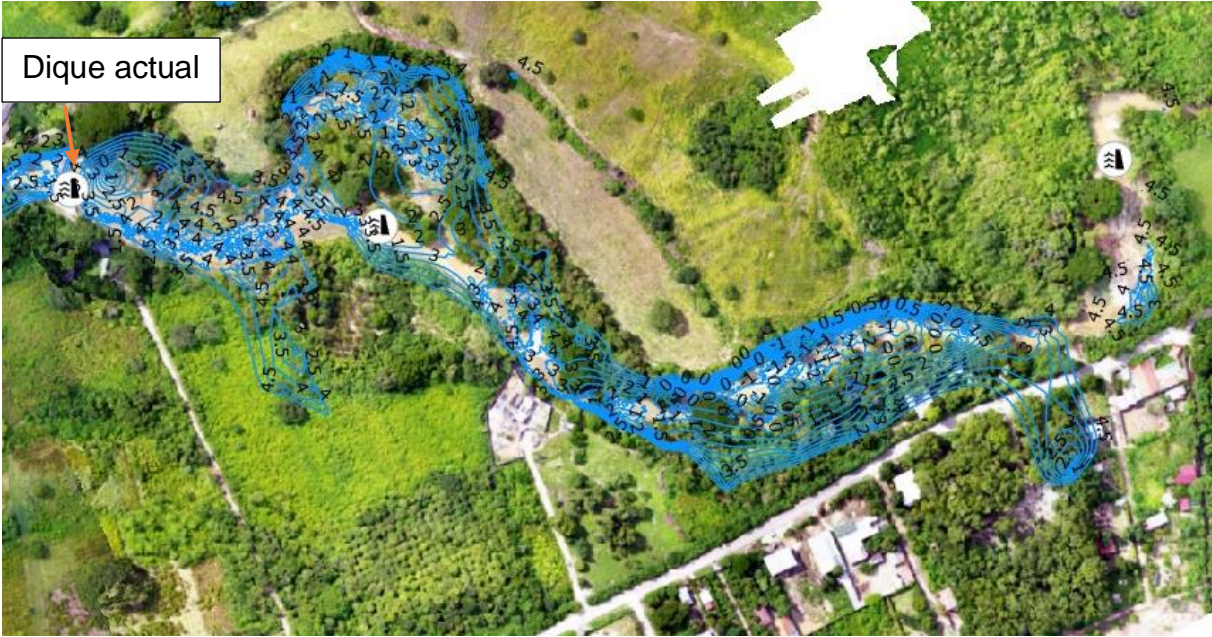
Ilustración 3-9 Llanura de inundación del dique actual
