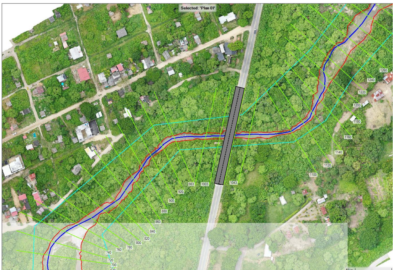
Ilustración 3-6 Simulación del puente
