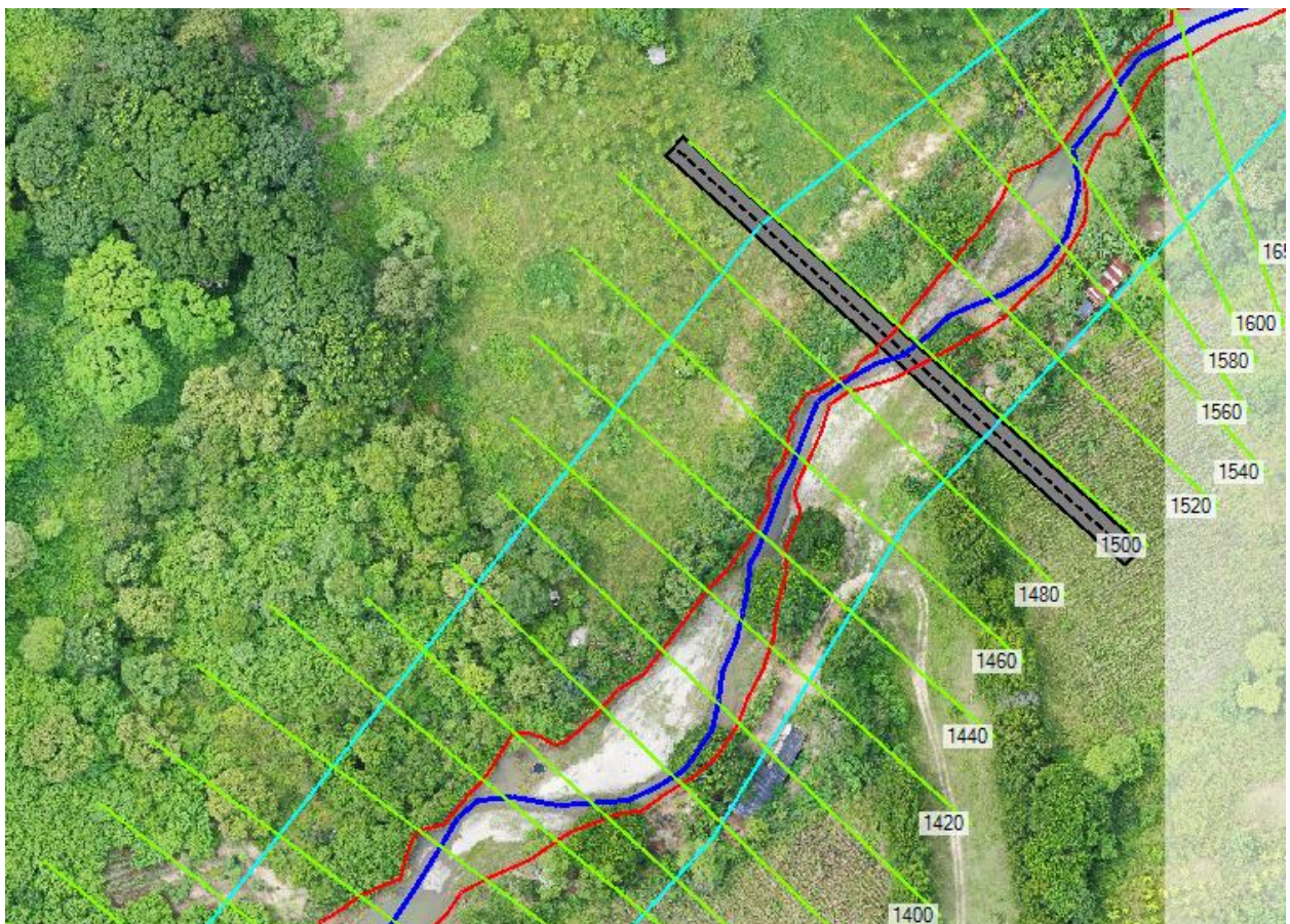
Ilustración 3-12 Simulación del dique propuesto
