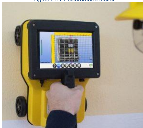
Figura 2.18 Escaner de hormigón
