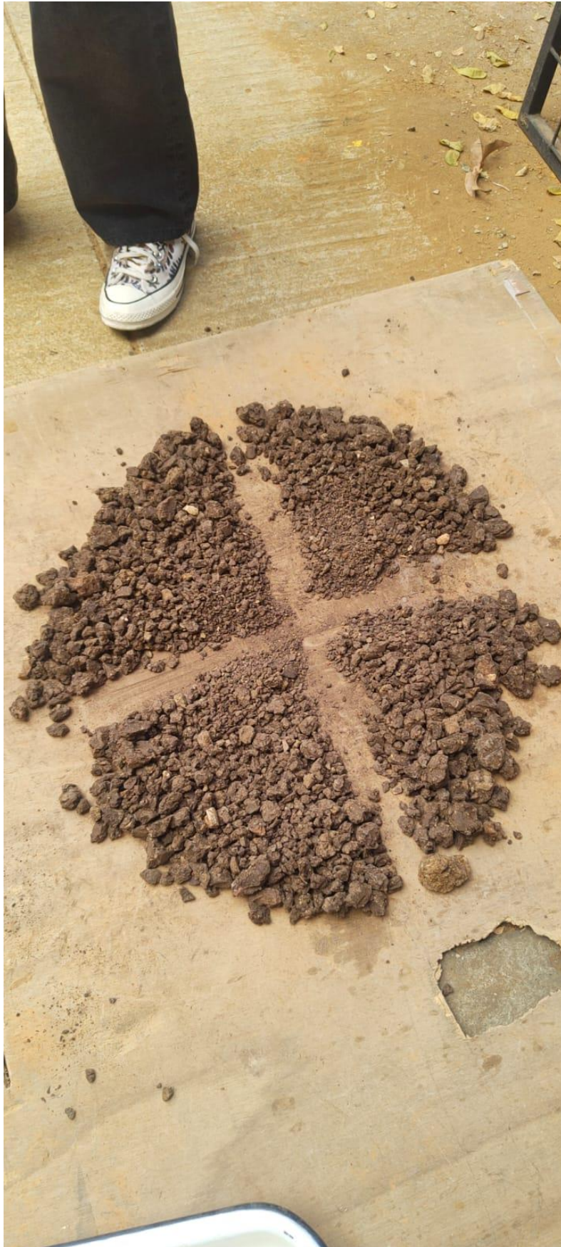
Figura 63 Cuarteo de muestra
