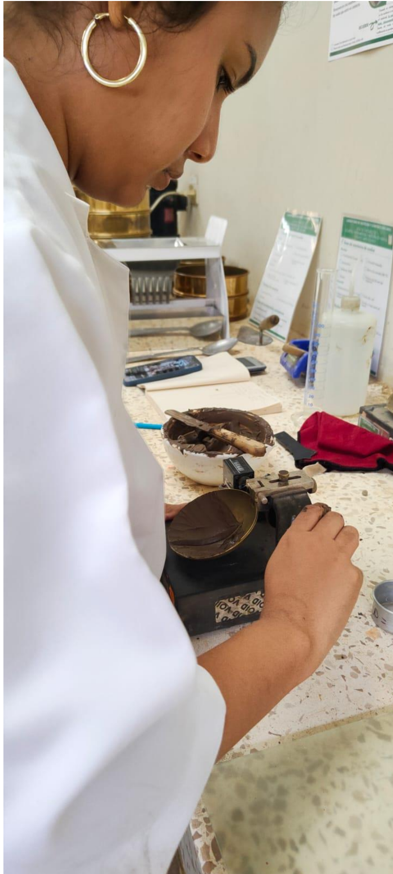
Figura 64 Ensayo de consolidación
