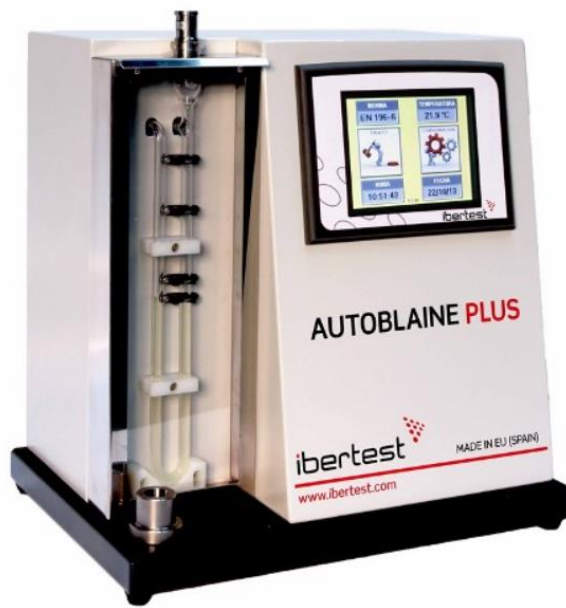
Figura 2.6 Equipo de permeabilidad
