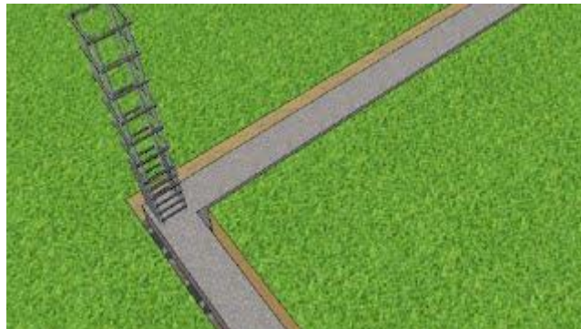
Ilustración 3.36. Viga de cimentación
