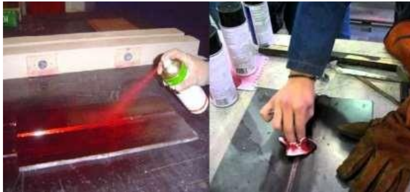
Figura 11 Líquidos penetrantes (soldaduras, 2020)
