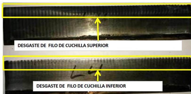
Figura 3.23 Desgaste de las cuchillas de la Línea de Producción
