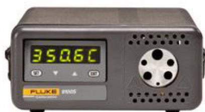
Figura 1.13: Horno seco manual 9100S/9102S para temperatura
