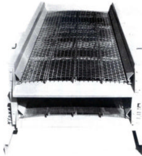
Figura 3.24 Zaranda de 2 Pisos con Mallas Instaladas.
