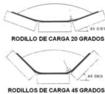
Figura 3.16 Efecto Angulo de Carga de los Rodillos con la Banda
