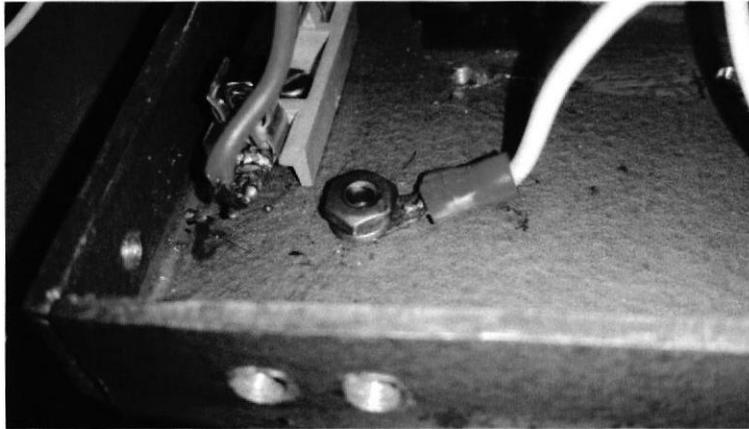
Figura 4.17. Cable de tierra conectado al chasis.
