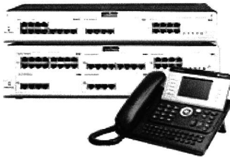
Gráfico 05.- Sistema telefónico IP Alcatel OmniPCX Office.
