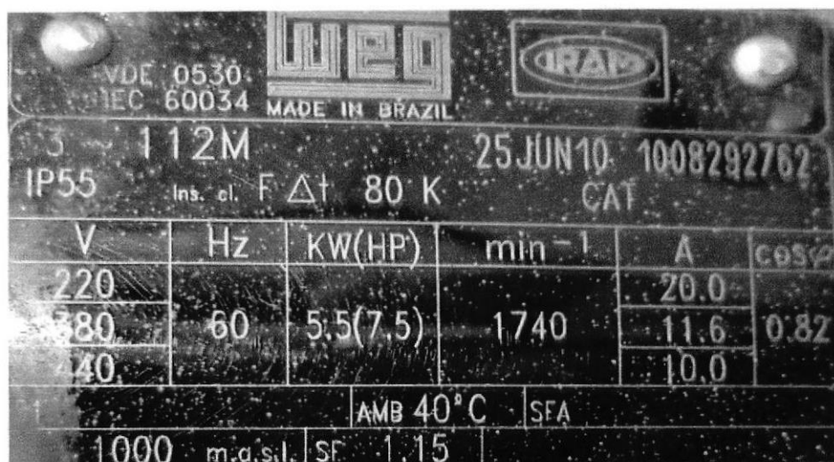
Figura 14.- Se puede ver la placa del motor área de refinación
