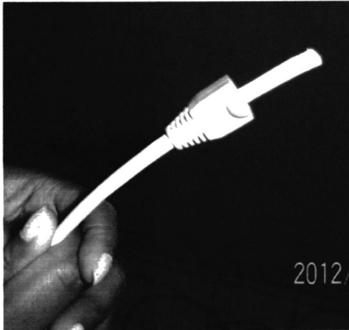
FIG. 20: Bota y cable UTP
