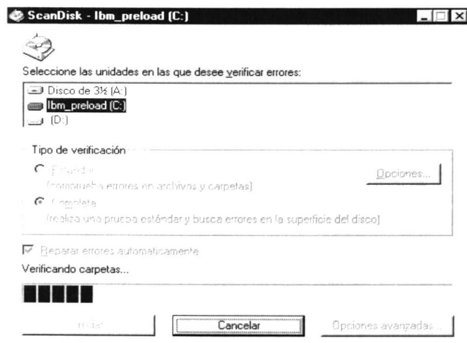
Figura 2.32 Verificando errores del disco con Scandisk.
