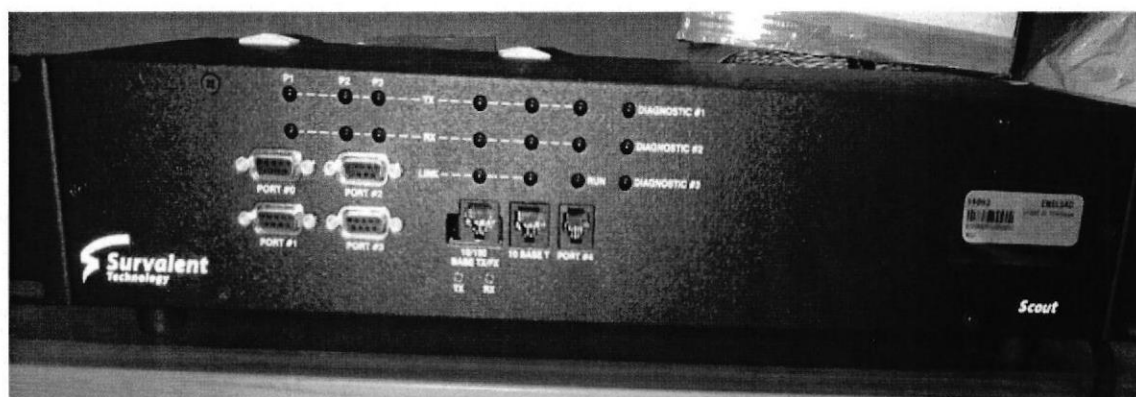
Gráfico 3-2.- RTU: Unidad Terminal Remota
