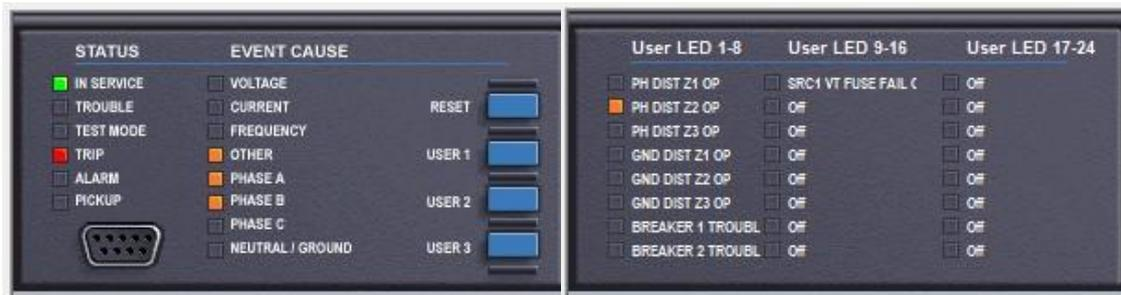
Figura 3.39 Proyección virtual del HMI del relé GE L90 según el disparo al 87 % de la línea.
