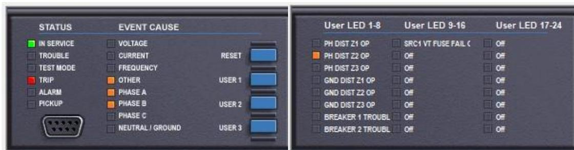
Figura 3.35 Proyección virtual del HMI del relé GE L90 según el disparo al 120% de la línea.
