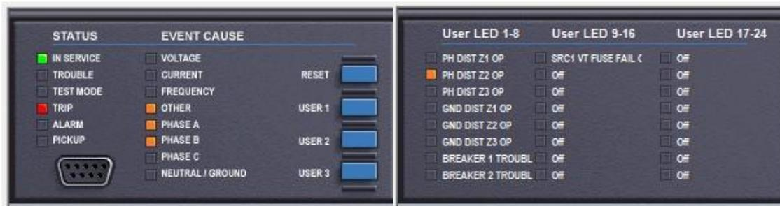
Figura 3.37 Proyección virtual del HMI del relé GE L90 según el disparo al 105% de la línea.
