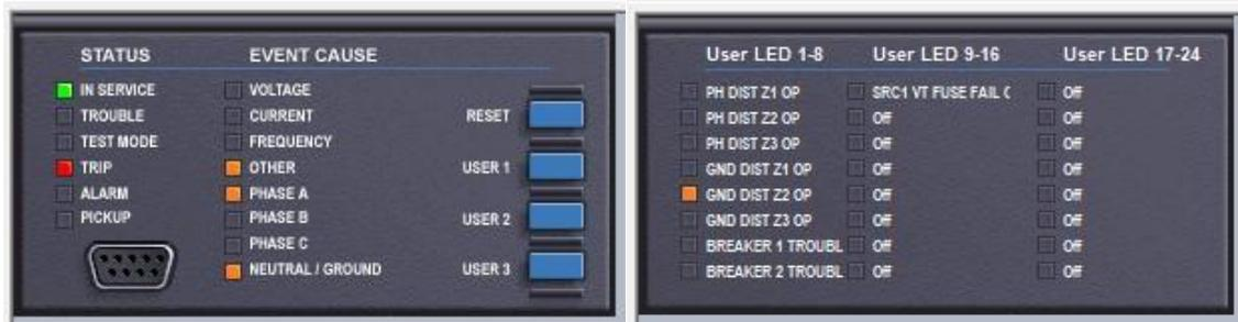
Figura 3.31 Proyección virtual del HMI del relé GE L90 según el disparo al 105% de la línea.
