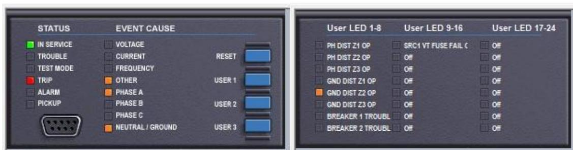
Figura 3.27. Proyección virtual del HMI del relé GE L90 según el disparo al 120% de la línea.
