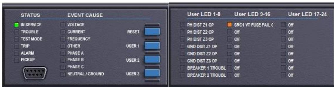
Figura 3.29 Proyección virtual del HMI del relé GE L90 según el disparo.
