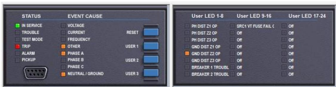
Figura 3.33 Proyección virtual del HMI del relé GE L90 según el disparo al 87% de la línea.
