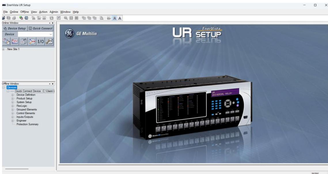
Figura 2.72 Interfaz Enervista de configuración de relé GE L90.
