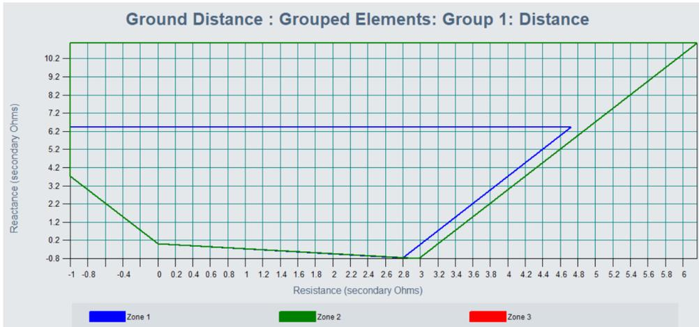
Figura 2.74 Zonas coordinas en el plano X-R para la protección ground distance.
