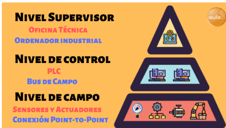
Figura 1. Niveles del proceso de automatización industrial [3]
