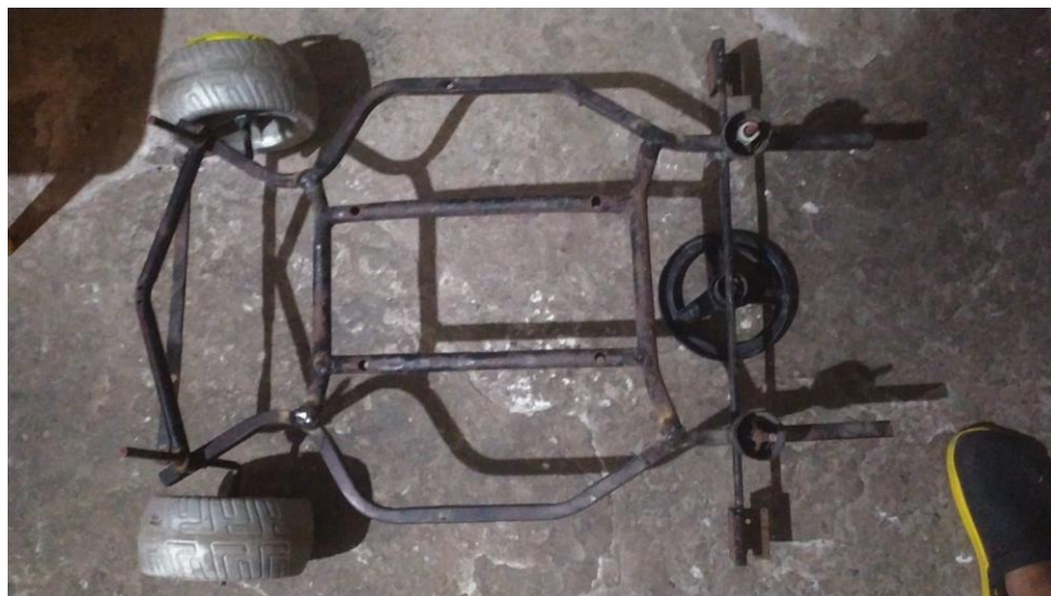
Figura 35 Chasis modificado del prototipo
