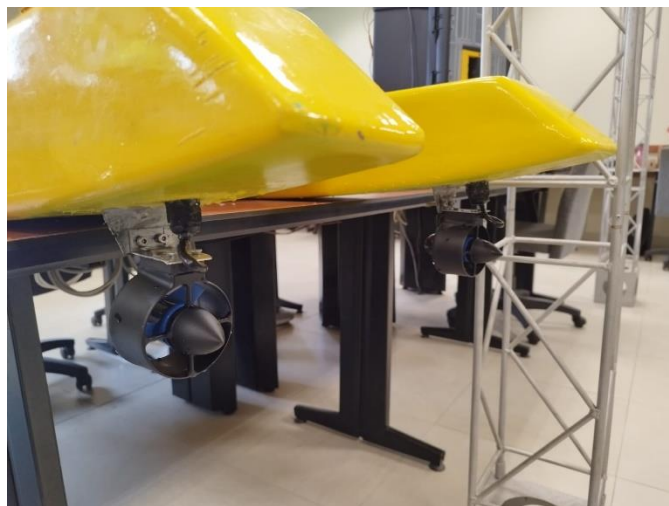
Ilustración 24 Nuevos motores con placas de acero inoxidable colocados en el bote
