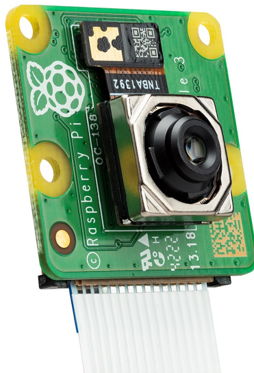
Figura 1.3: Módulo de cámara para Raspberry Pi.
