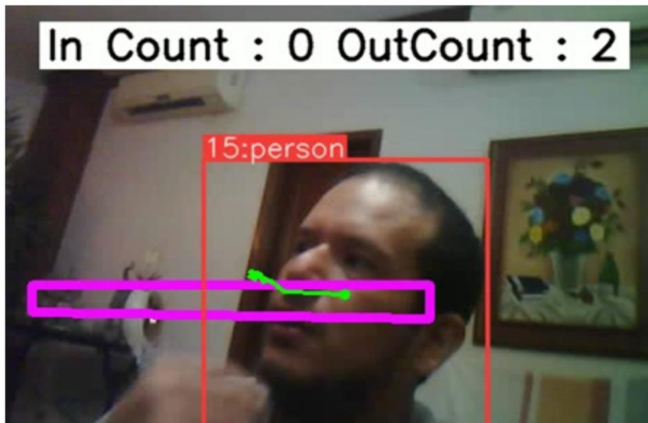
Figura 3.12: Captura de pantalla del funcionamiento del programa de conteo. Se ve un rectángulo formado por dos líneas de control, sobre cuyo tránsito se define el ingreso o egreso.
