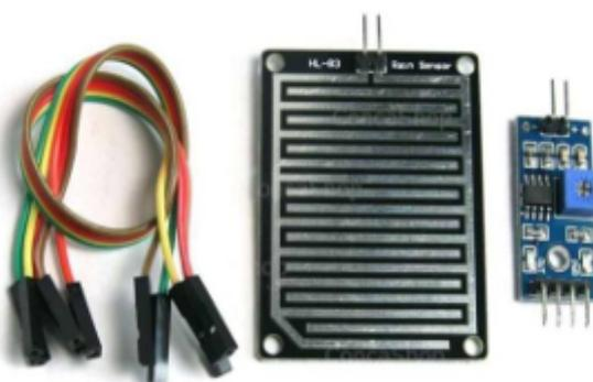
Figura 2.4: Sensor de lluvia + placa LM393. Fuente: Szks-Kuongshun, 2024
