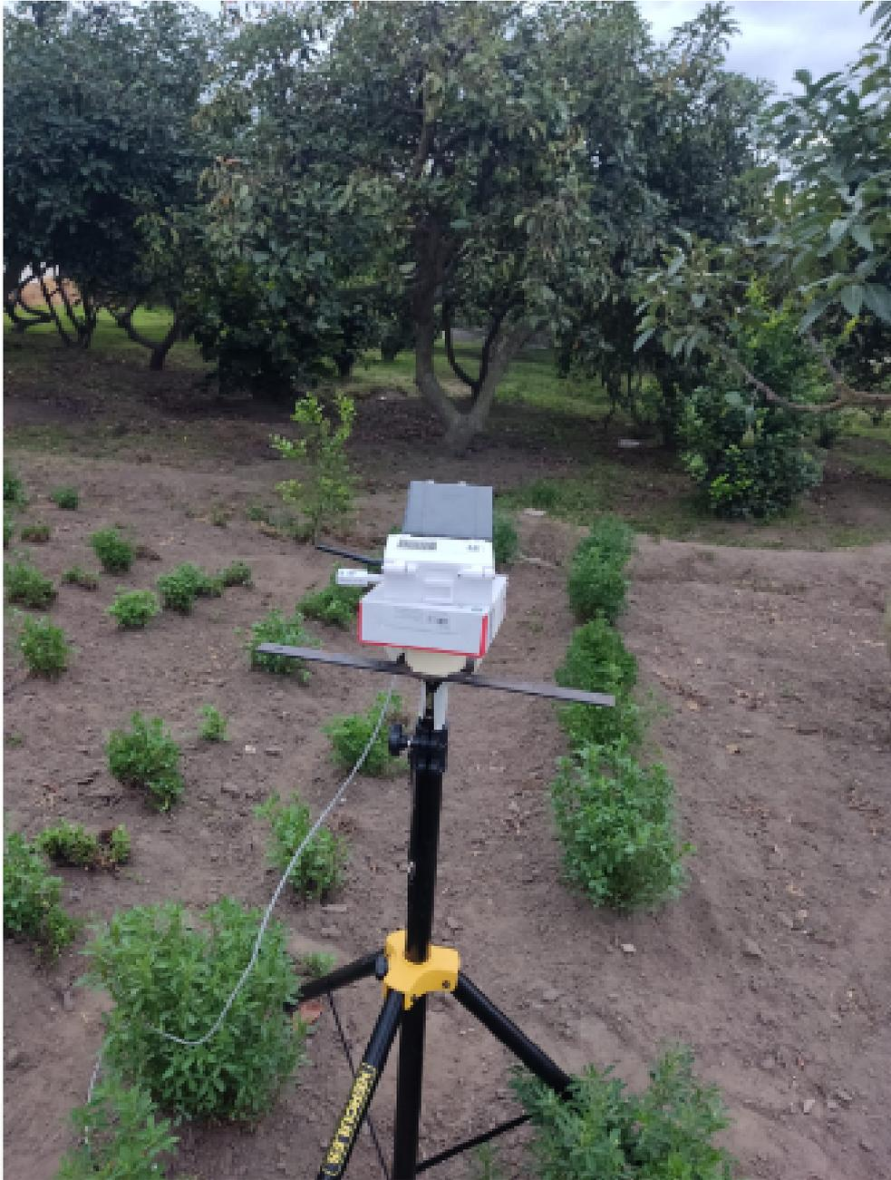
Figura 4: Prueba del nodo recopilando datos en el campo
