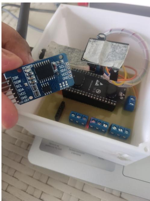
Figura 3.7: Desconexión del Módulo RTC - Preparación para Sincronización
