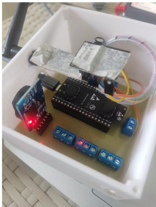
Figura 3.8: Reinstalación del Módulo RTC - Listo para Sincronización.
