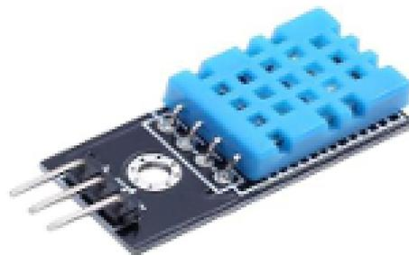
Figura 2.6: Sensor de Humedad y Temperatura DHT11. Fuente: Rambal, 2024
