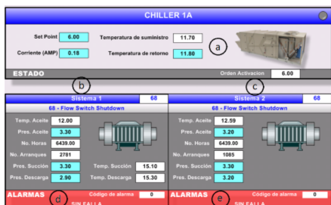
Figura 2.15 Pantalla Monitoreo Chillers
