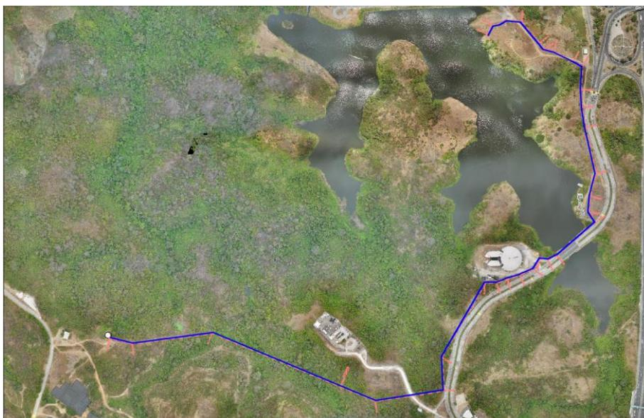
**2.5.6.3 Alternativa 3. Diseño de captación y de la línea de impulsión con proximidad a garita PARCON.** Durante la visita de campo, se observó que esta alternativa cuenta con el acceso suficiente para el personal destinado para la instalación y posterior mantenimiento del sistema de bombas. Además, presenta una longitud de 0+720 m de nueva intervención y longitud total hasta la PTAP de 1+900 m.
