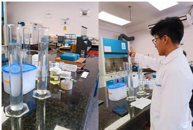
**3.1.4.2 Medición del cloro libre.** Se preparó un blanco de 10 mL de muestra en un vial para encerrar el colorímetro, posterior a esto, se colocó 10 mL de muestra clorada en un nuevo vial y se empezó con la medición de cloro libre. En la figura (3.11 y 3.12) y en la tabla (3.8) se muestran los resultados.
