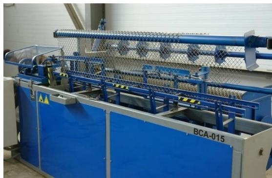
En la tabla 2 se detallan las características técnicas del BCA-015 destacando una notoria disminución en el consumo eléctrico en comparación a su hermano menor BCA-97, de igual manera en el peso de la máquina.
