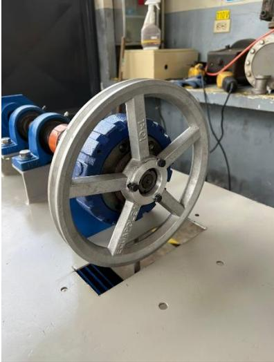
Una vez instaladas las poleas de 10 pulgadas y la polea de 3 pulgadas (esta última integrada con el motor proporcionado por el cliente), se colocó la banda que inicialmente se tenía planificado que fuera plana. Sin embargo, se optó por utilizar una banda en V, ya que suele ser más eficiente en la transmisión de potencia y presenta menos tendencia al deslizamiento debido a su forma en V (Ilustración 33).
