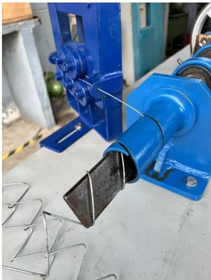
En la ilustración 45, se observa la elaboración de un metro de alambre eslabonado, esto sugiere que tanto el sistema de reducción de velocidad, liderado por el variador de frecuencia, como el sistema de transmisión de potencia, compuesto por el sistema de poleas, fueron diseñados de manera que la funcionalidad de la máquina sea óptima. Este enfoque asegura el cumplimiento exitoso del objetivo principal del proyecto.
