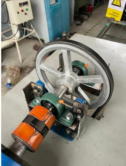
Adicionalmente, se fabricaron dos bases para las chumaceras utilizando ángulos. Estos fueron cortados y soldados para lograr la altura deseada, asegurando así que las chumaceras permitan que el eje se mantenga nivelado, tal como se observa en la ilustración 38.
