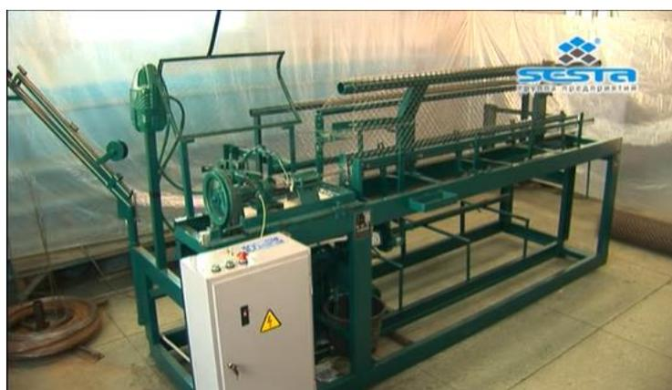
En la tabla 1 se muestran las características técnicas de la BCA-97. Según el fabricante, esta ha demostrado alta confiabilidad operativa. La máquina no requiere supervisión especial de instalación; simplemente se necesita un operador para manejar de 2 a 3 máquinas, adicionalmente se requiere un espacio de 18 metros cuadrados para un funcionamiento normal [6].
