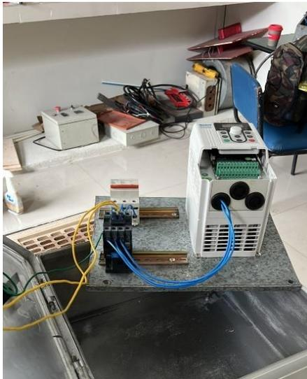
Una vez montado el circuito, se incorporó un selector de dos posiciones para la operación (Ilustración 27). Este selector se energiza mediante el contactor de 12 A y se conecta a la entrada de la luz piloto verde, así como a la parada de emergencia para mayor seguridad. En la salida, se conecta a la luz piloto amarilla y, a su vez, a la parada de emergencia, creando un retorno hacia el contactor de 12 A (Ilustración 28).
