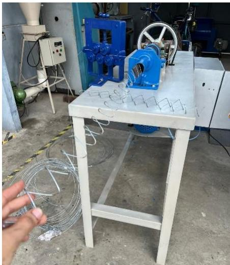
En la ilustración 46, se aprecia el proceso de tejido del alambre eslabonado para formar una malla. Este procedimiento se lleva a cabo de manera manual por el operario. No obstante, es importante señalar que los planos originales incluían una mesa de mallado, la cual, lamentablemente, se encuentra extraviada. Por lo tanto, será necesario fabricar dicha mesa para asegurar la correcta operación.
