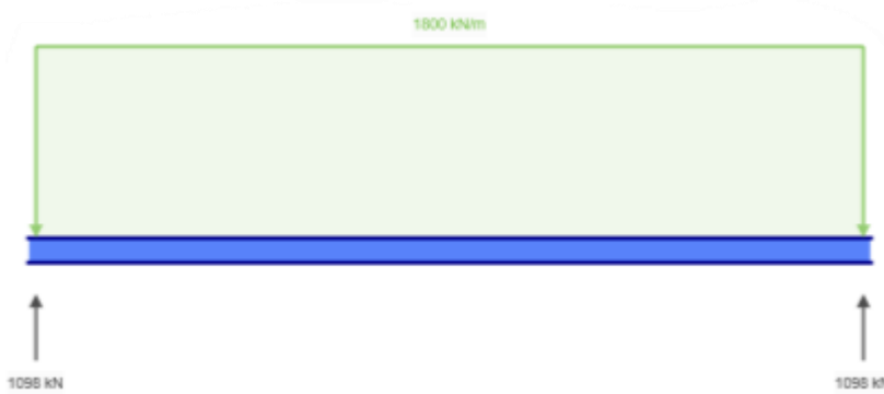
Figura 20 Representación de las fuerzas presentes el momento del rolado en el rodillo de empuje
