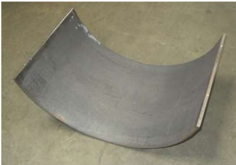
Figura 5 Proceso de rolado
