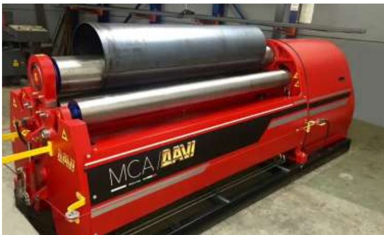
Figura 2 Máquina roladora de 4 rodillos MCA series
