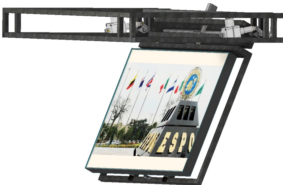
Figura 3.58 Diseño final del tercer grado de libertad, con el Tv incluido para mejor visualización del cliente.
