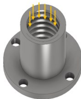
Figura 2.15 Fuerzas provocando esfuerzo normal en las cuerdas de la tuerca.
