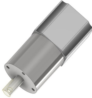
Figura 3.44 Motor en el programa inventor, transmitirá el torque y velocidad necesario para el segundo grado de libertad.
