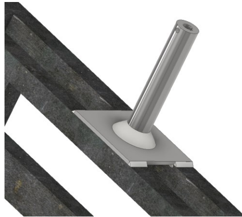
Figura 3.42 Cordones de soldadura entre el árbol de transmisión la estructura 1 y la placa fina.
