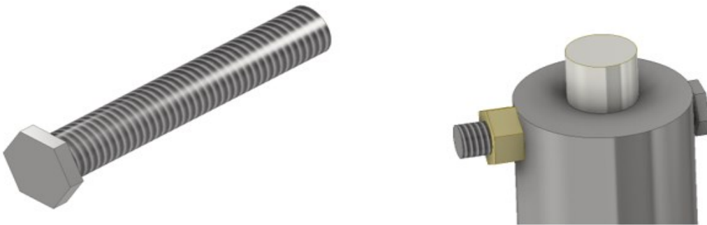
Figura 3.40 Pasador en el programa inventor, posición que tendrá el pasador, será puesto en medio del árbol y el eje de la caja reductora.
