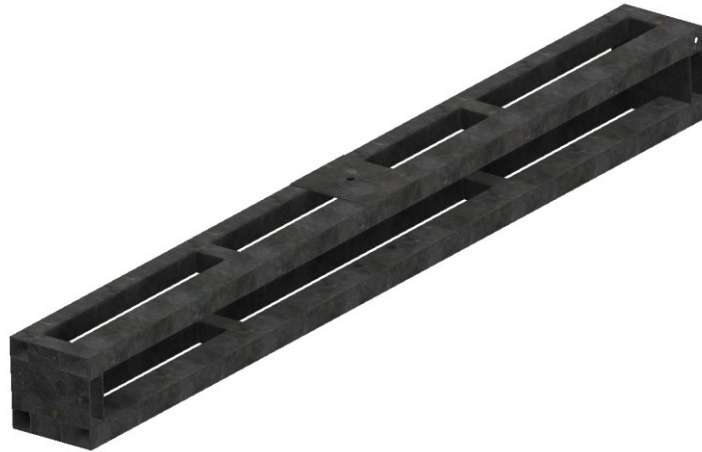
Figura 3.37 Estructura que compone el segundo grado de libertad, perfiles estructurales de acero A36.
