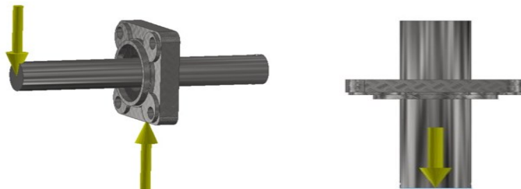
Figura 2.36 Análisis estático en posición horizontal y vertical para el diseño de la selección de rodamientos.
