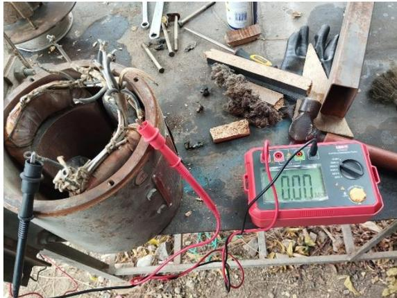
Entre los elementos que deben ser reemplazados se tienen, principalmente rodamientos y pernos debido a la antigüedad de estos. Luego de realizar pruebas eléctricas, se determinó que el motor necesita repararlo, por lo que se envió a un taller para su revisión.
