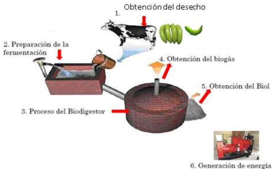
Figura 6.4 Proceso de Obtención del Biogas y Biofertilizante
