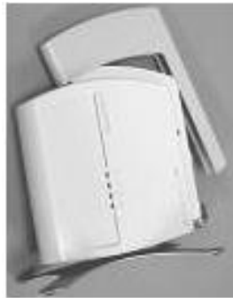
Figura. 5.8 Remover el protector frontal del suscriptor
