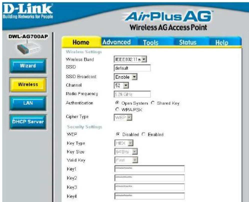
Figura. 5.28 Ventana ( 1) Parámetros de la Interfaz Inalámbrica
