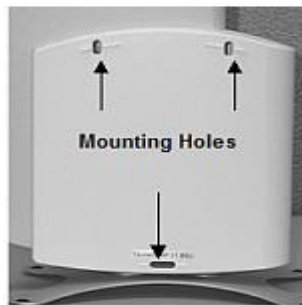
Figura. 5.9 Perforaciones del suscriptor
